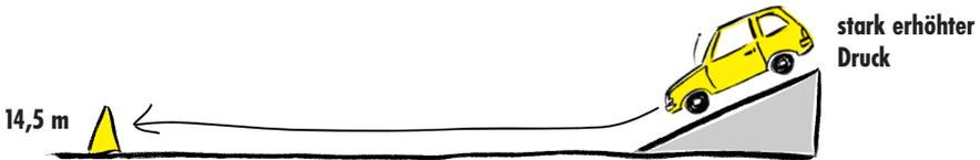
**Rollweite mit Normaldruck: 13,0 m; mit stark erhöhtem Reifendruck: 14,5 m.**
