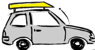
Grundträger mit aerodynamisch geformtem Dachkoffer: + 1,5 l/100 km
